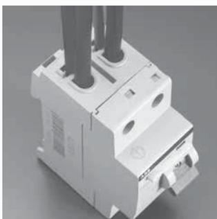
V systémech bez propoj. lišt je možno pro připojení vodičů s různými průřezy využít dvě připojovací místa připojovacích svorek: napájecí vodiče do 50 mm<sup>2</sup> (pomocí předvápné svorky) do přední svorky.
